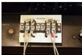
スピーカー・ケーブルの接続 (ウーファー・アンプ側)
