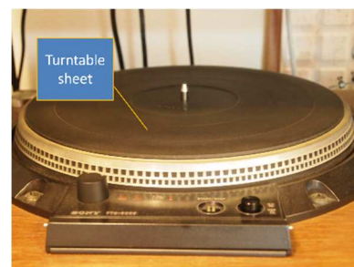
ターンテーブル・シート ゲルが充填されているため、振動を吸収する。
