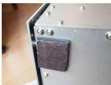
プリアンプ PA-210 のインシュレーター ブチルゴム、ハネナイト・ゴム、5mm 厚フェルトからなるインシュレーター。効果は抜群。
