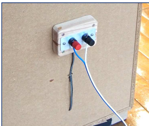
背面に取り付けられた手作りの端子板。
